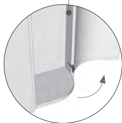
particolare apertura anta door opening detail
